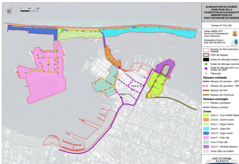
Figure 26. Plan des zones du domaine portuaire à raccorder à la STEP de Papeete – schéma directeur de la transition écologique et énergétique du Port autonome de Papeete
